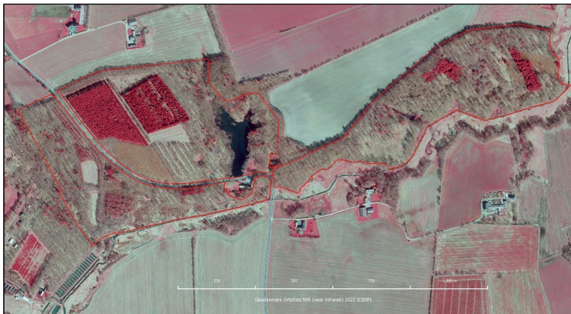
Figur 8: Ortofoto NIR (near infrared) fra 2022, der viser forekomsten af nåletræer, da de træder meget tydeligt frem, eftersom billedet er optaget før løvspring. Projektgrænsen er markeret med rød streg.
